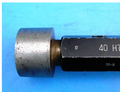
写真 5 錆びているプラグゲージ
